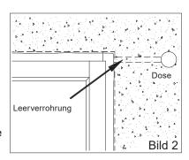
Ist eine Automatik-Steuerung mit Niederspannung vorgesehen, so sind für die Steuerleitungen getrennte Leerrohre vorzusehen.
