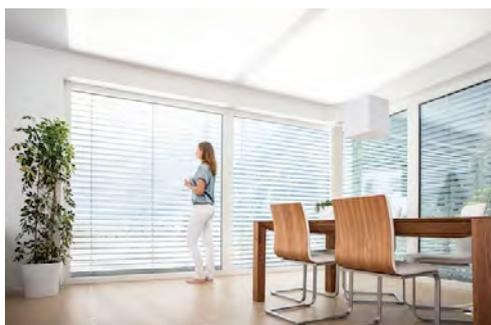
*Der Tageslichtraffstore RETROLux spart wertvolle Energie für künstliche Beleuchtung und Kühlen – und das bei bester Durchsicht nach draußen.*
